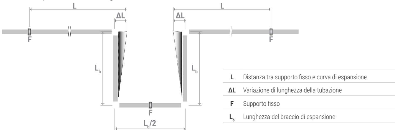
La lunghezza minima del braccio di espansione ( $L_b$ ) può essere calcolata utilizzando la seguente formula:  $L_b = C \times \sqrt{\varnothing_e \times \Delta L}$
