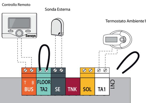
**Schema elettrico caldaia**
